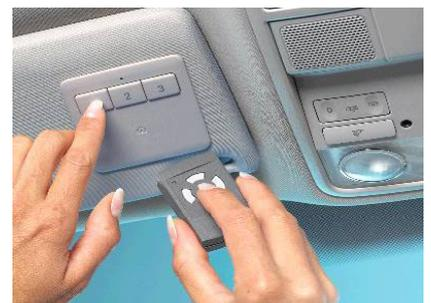
4. Die HomeLink-Leuchtdiode blinkt, zunächst langsam und dann schnell. Wenn die Leuchtdiode schnell blinkt, lassen Sie beide Tasten los. (Das schnelle Blinklicht zeigt an, dass das neue Frequenzsignal erfolgreich programmiert wurde).
