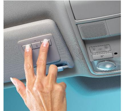
2. Halten Sie den Original-Handsender des Geräts, das Sie anlernen möchten, in einer Entfernung von etwa 5-30 cm zur HomeLink-Sendereinheit und behalten Sie dabei die Leuchtdiode im Blick.
