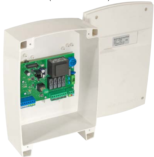
Ampelsteuerung STA 10 (STA 11) im Gehäuse IP 54 (210 x 310 x 125mm)
