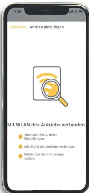
Nach dem Einstecken muss das Modul durch das Scannen des QR-Codes oder durch die manuelle eingabe des Passwortes mit dem TCON Wlans verbunden werden.
